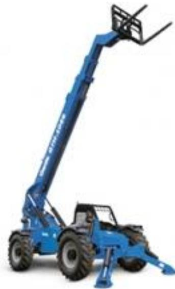
Figura 4 Manipulador Diesel
