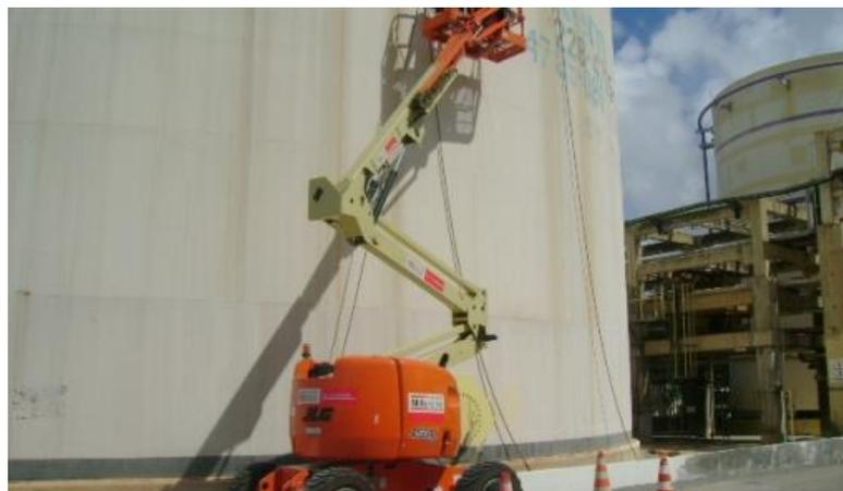
Figura 2 Plataforma Articulada Diesel (MILLS, 2017)
